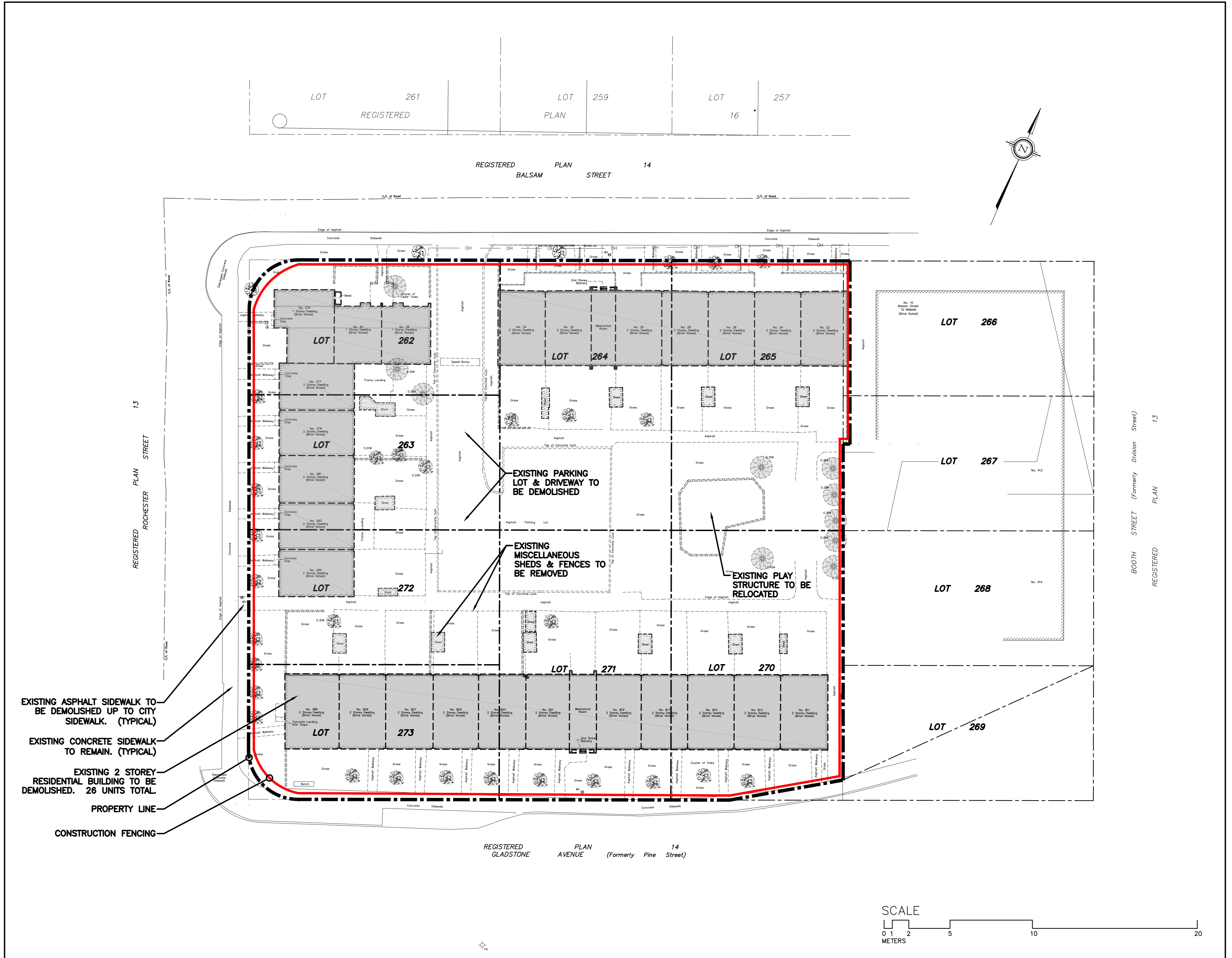
2 DEMOLITION SITE PLAN A-1 1 : 250
