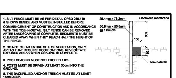
6. THE BACKFILL MUST BE COMPACTED.
