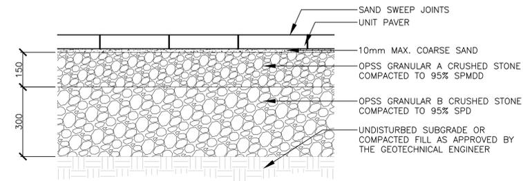
3 UNIT PAVING Scale: 1:10
