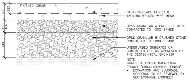
1 CONCRETE PAVING Scale: 1:10
