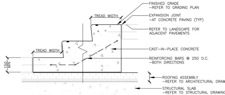
5 CONCRETE RISERS Scale: 1:10
