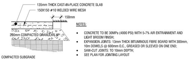
**7** **CAST IN PLACE CONCRETE PAVING**
