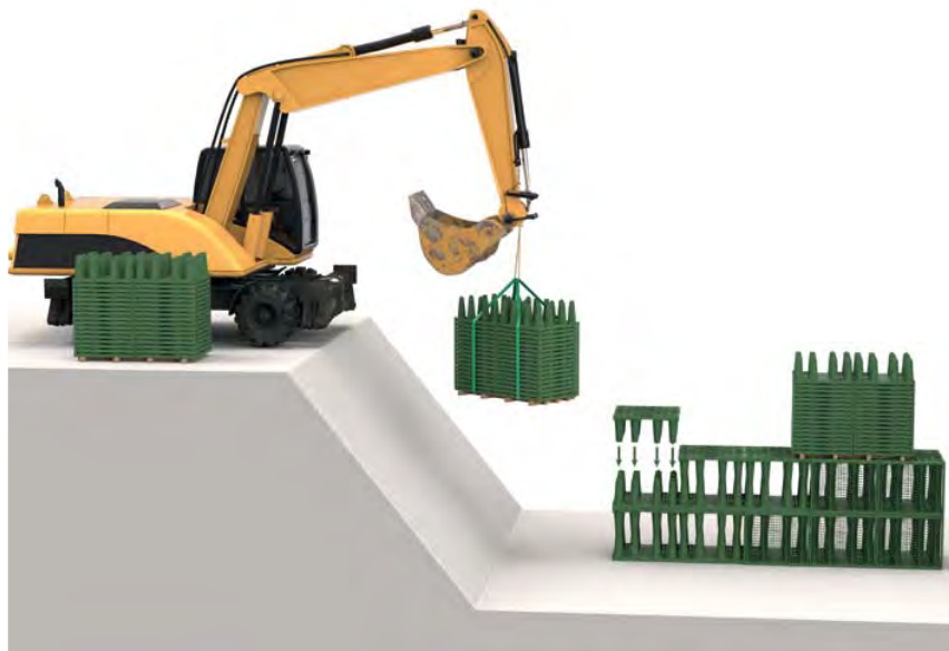
Montage dans la fouille
